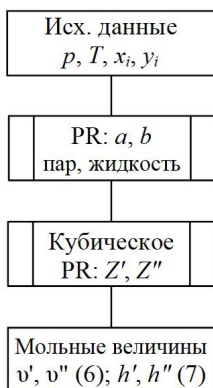
Рис. 2. Блок-схема расчета термодинамических параметров (ТД)
