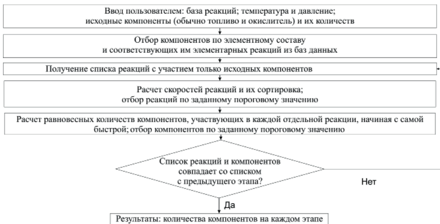
Рис. 1. Алгоритм анализа детального механизма химической реакции Fig. 1. Algorithm for analyzing the detailed mechanism of a chemical reaction
