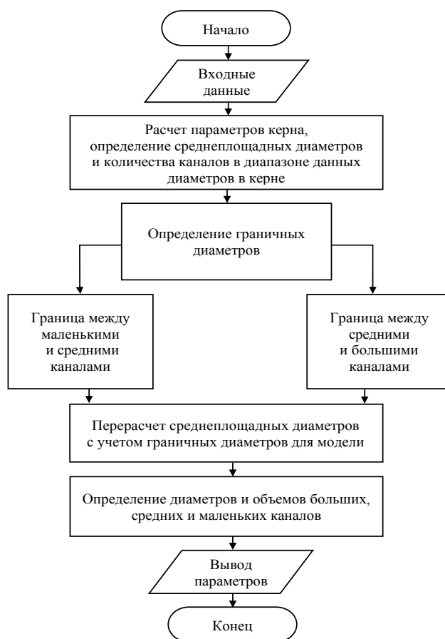
Рис. 1. Блок-схема алгоритма расчета параметров порового пространства
