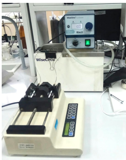
Рис. 7. Схема установки для оценки влияния ВЧ и СВЧ ЭМ обработок на величину отложений нефти на стенках трубопроводов
