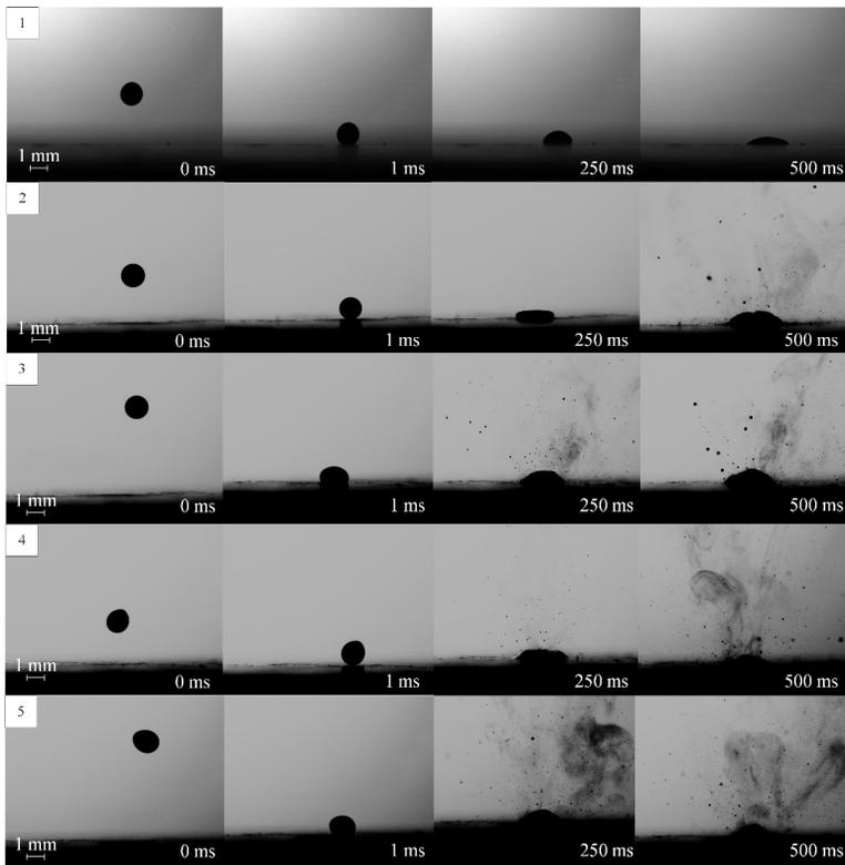
**Рис. 6.** Типичные видеокadres столкновения каплей водомазутных эмульсий с твердой разогретой поверхностью при варьировании ее температуры: 1 — режим растекания при температуре подложки 100 °С для состава № 2; 2–5 — режим дробления для составов № 2–5 при температуре подложки 200 °С
