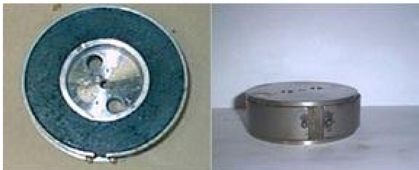
Рис. 4. Ячейка для определения усадки цементного камня по API 10B-5
