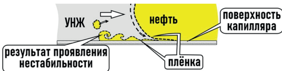
Рис. 6. Механизм вытеснения нефти с образованием гофрированной наноструктурированной пленки
