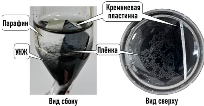
Рис. 2. Образование наноструктурированной плѐнки на межфазной границе УНЖ–парафин
