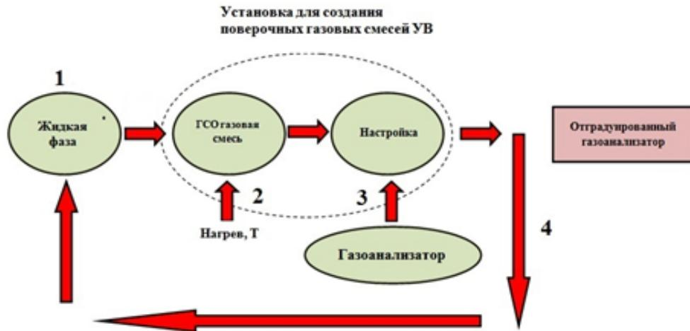
Рис. 3. Блок-схема настройки/ градуировки газоанализатора; пояснения в тексте
