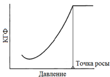
Рис. 1. Схематическая зависимость КГФ от давления смеси [Дурмишьян, 1979]
