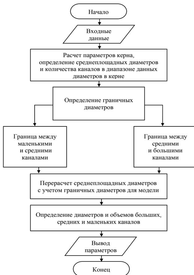
Рис. 1. Блок-схема алгоритма расчета параметров порового пространства
