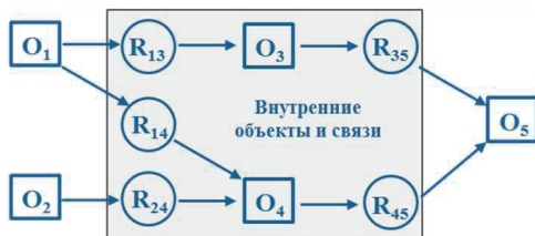
Рис. 3. Представление геолого-математической модели в виде ориентированного двудольного графа
