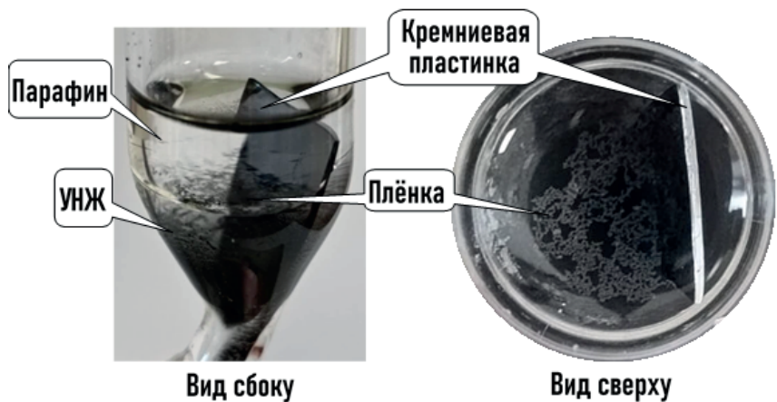
Рис. 2. Образование наноструктурированной плѐнки на межфазной границе УНЖ–парафин
