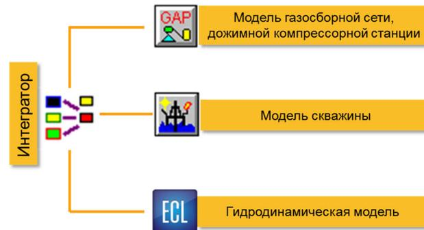
Рис. 2. Архитектура интегрированной модели пласта Т
