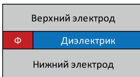
Рис. 1. Общая структура мемристора для численного моделирования; Ф — проводящая нить (филамент)
